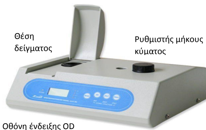
Εικόνα 5. Βασικά μέρη φασματοφωτομέτρου ( https://www.quirumed.com/ )
