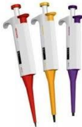
Εικόνα 2. Αυτόματες πιπέτες ρυθμιζόμενου όγκου (κόκκινη: 2-20 μl, κίτρινη 20-200 μl, μωβ: 100-10.000 μl)
